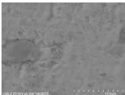
Рис. 5. Микрофотография необработанного носителя (SS).
