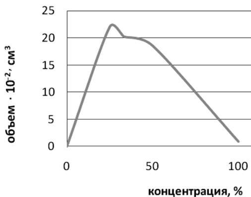
Рис. 2. Влияние концентрации раствора на пенообразование.
