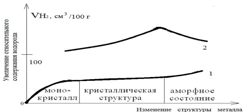
Рис. 2. Зависимость степени поглощения водорода от структуры металла:
