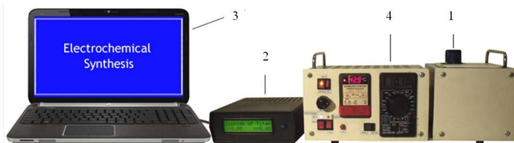
Рис. 2. Оптический анализатор растворов (ОНПВО)-2ФА) сульфата титана(III) при  $\lambda_{470}$ : 1 – термостатируемый блок с оптической системой; 2 – регистратор – интерфейс; 3 – компьютер; 4 – блок управления.
