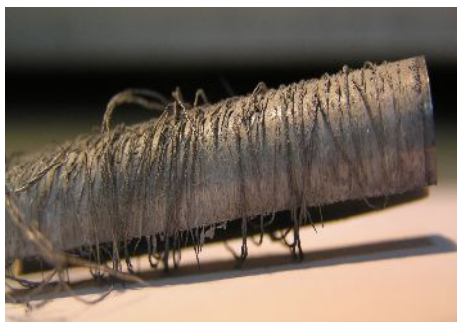
Рис. 3. Нитевидные дендриты, полученные в тетрафторборатном электролите в присутствии УНТ.
