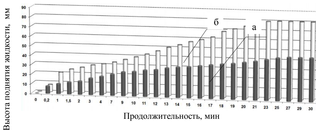
Рис. 3. Кинетические кривые смачивания раствором мономеров: а – ПАН; б – НФФ волокон
