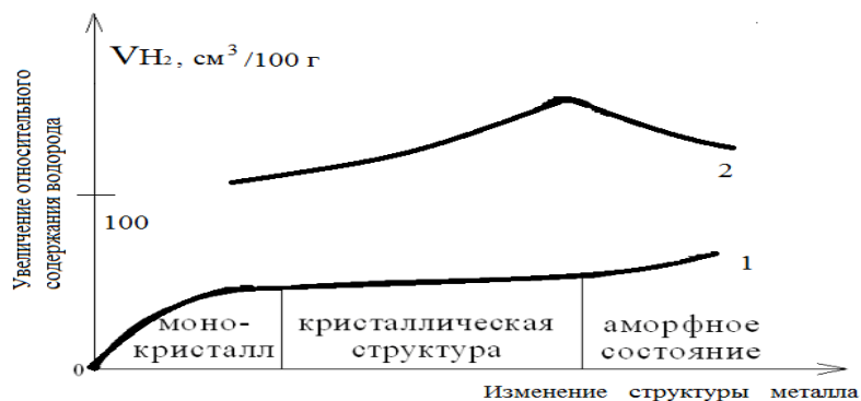
Рис. 2. Зависимость степени поглощения водорода от структуры металла: 1 – гипотетический металл; 2 – электрохимическая система (Ni–B–H)
