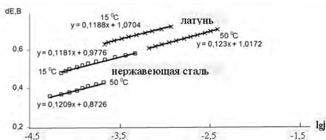
Рис. 4. Зависимость логарифма плотности силы тока от перенапряжения для электродов из латуни и нержавеющей стали в растворе 1,0 \text{ моль/дм}^3 \text{ H}_2\text{SO}_4 при температуре 15^\circ\text{C} и 50^\circ\text{C} .
