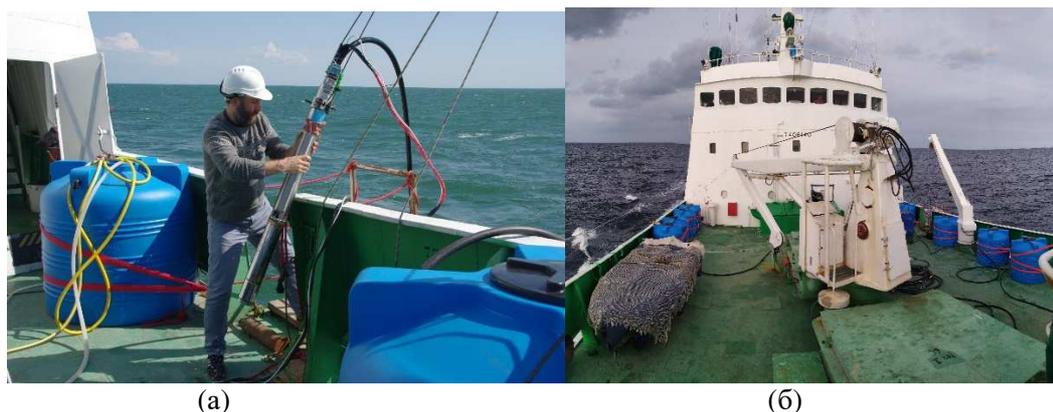
Рис. 1. Погружной насос для отбора проб морской воды (а) и расположение баков (б) на судне.
