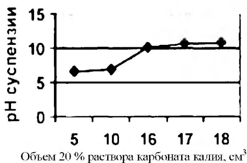
Рис. 2. Зависимость pH суспензии от количества карбоната калия при 333 K.
