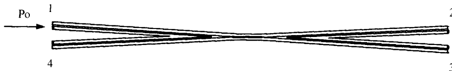
Рис. 1. Структура биконического сужения разветвителя
