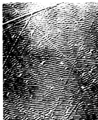
Рис. 2. Доменная структура образца № 1, H = 0
