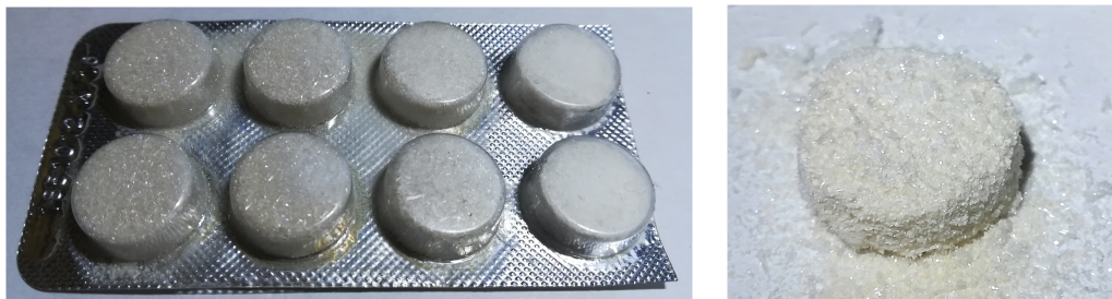
Рис 11. Образование кристаллов салициловой кислоты на таблетках AcSal при их длительном хранении.
